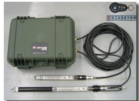
“遠隔監視型”光る変位計の構成
