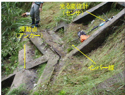
光る変位計と滑動点の連結状況
