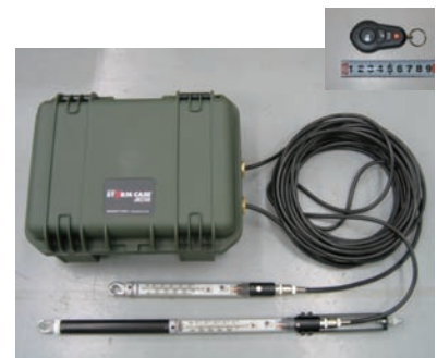
遠隔監視型光る変位計システム
