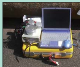
部材厚測定機器(超音波法)
